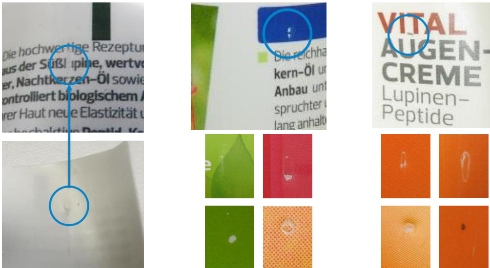
Abbildung 4: Partikel und Materialeinschlüsse als Störfaktoren für die Dekoration auf der Tubenaußenseite
