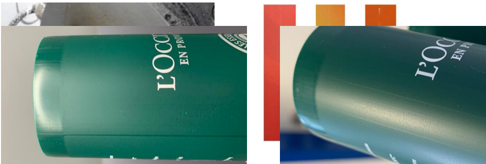
Abbildung 6: Kratzer beim Extrudieren
